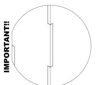
**IMPORTANT!!** ONLY USE FORCE AT CONNECTION POINT EDGE TO AVOID PANEL CRACK.
