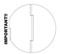
**IMPORTANT!!** ONLY USE FORCE AT CONNECTION POINT EDGE TO AVOID PANEL CRACK.
