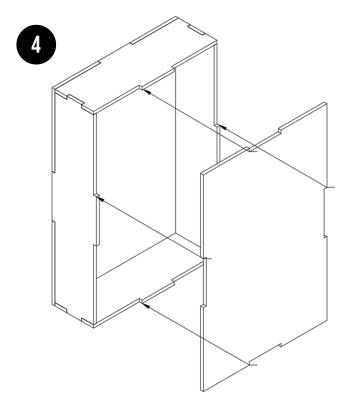
\*PLACE & ALIGN THE HOT WHEEL LONG CARD INTO THE BOX BEFORE INSTALLING THE CARD GUARD PANEL
